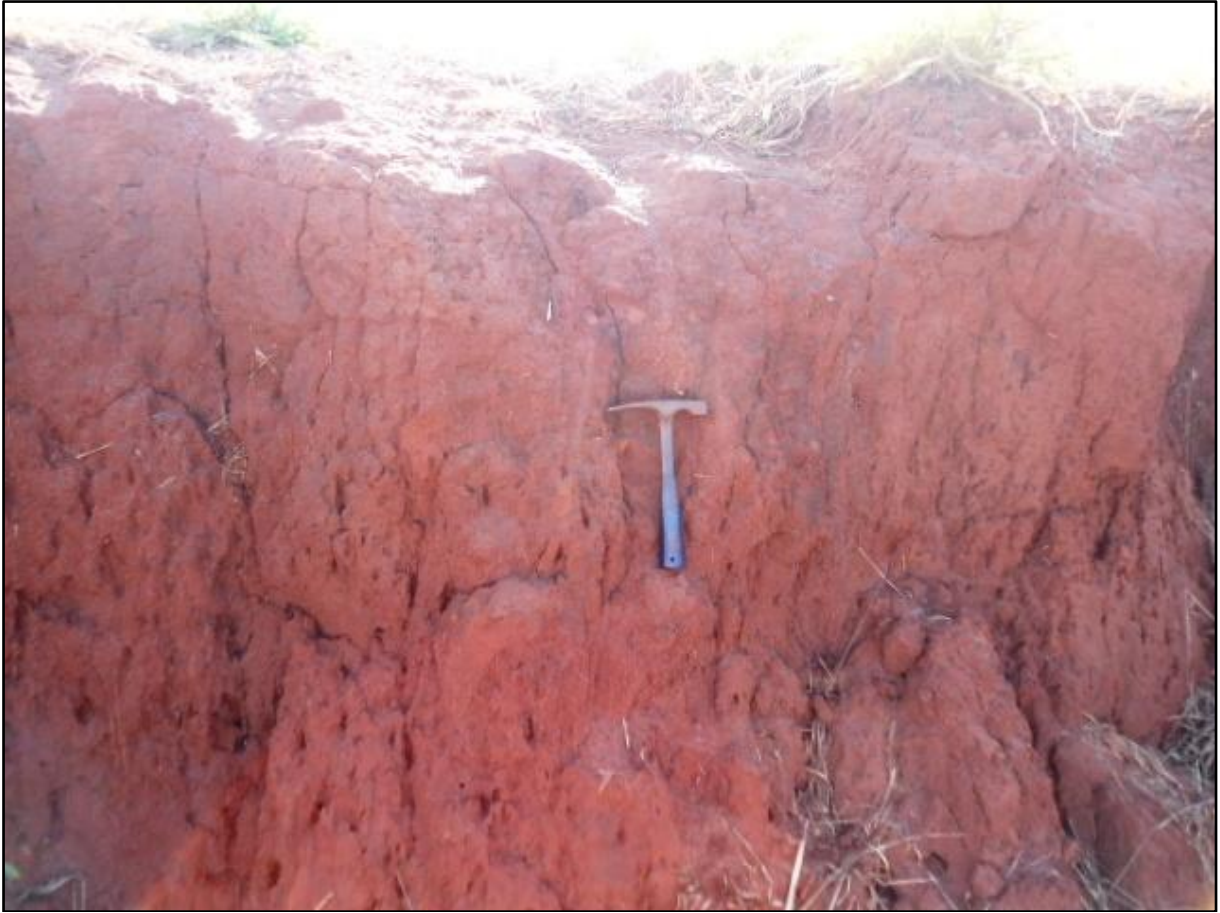
Figura 10 - Latossolo Vermelho Distrófico Típico “decapitado” e com o Horizonte B Exposto e Compactado – Fonte: MOREIRA, C. A.
