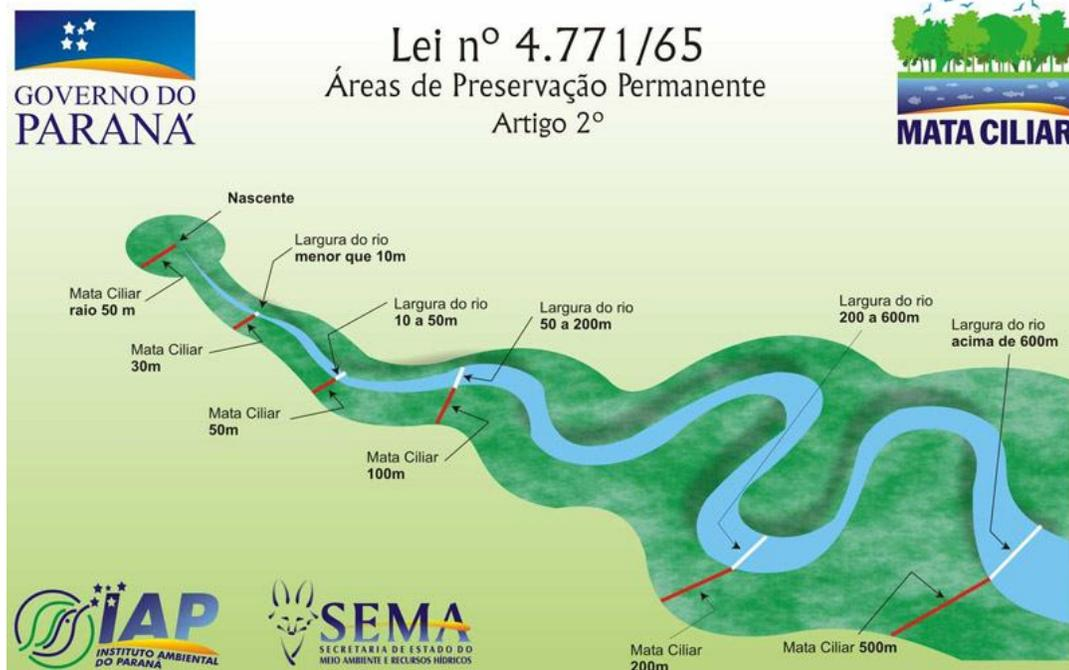
FIGURA 2 – Croqui esquemático das áreas de preservação permanente – Fonte IAP/SEMA
